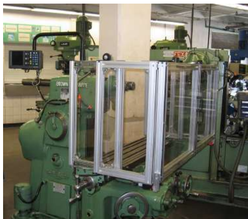
SÉCURISATION D'UNE FRAISEUSE MILLING MACHINE SAFEGUARDING
