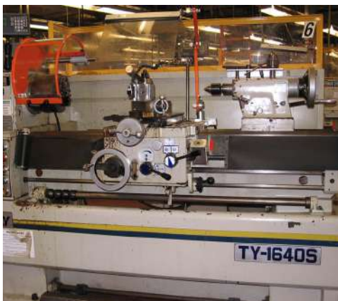
SÉCURISATION D'UN TOUR LATHE SAFEGUARDING
