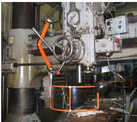
SÉCURISATION D'UNE PERCEUSE RADIALE RADIAL DRILL SAFETY GUARD
