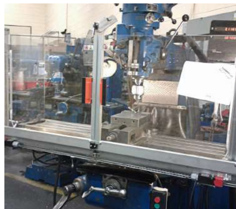
SÉCURISATION D'UNE FRAISEUSE MILLING MACHINE SAFEGUARDING
